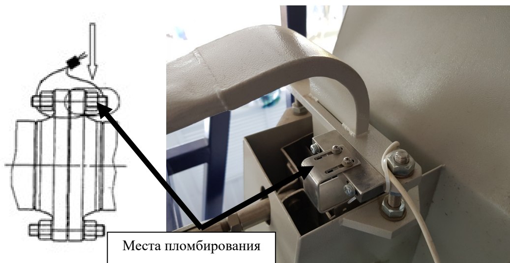
Рисунок 3 – Схема пломбировки от несанкционированного доступа, обозначение места нанесения знаков поверки на фланцевые соединения расходомеров и на оптодатчики положения перегородки устройства переключения потока (при их наличии) установок поверочных УПСЖ-ПРО
